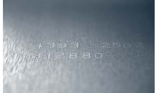
↑ Marquage sur une tôle
