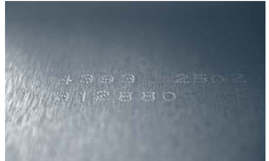
↑ Marquage sur une tôle
